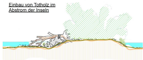
Totholz an eingebetteten Setzsteinen befestigt
